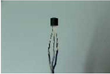
Imatge (43): Soldadura del sensor de temperatura
